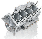
Kurbelgehäuse 944 2,7 Liter, ohne Kolben Teile-Nr. 94410096100
